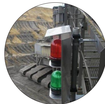
Averte sur la grande roue à godets dans l'exploitation à ciel ouvert de RWE: feu fixe à LEDs 280
